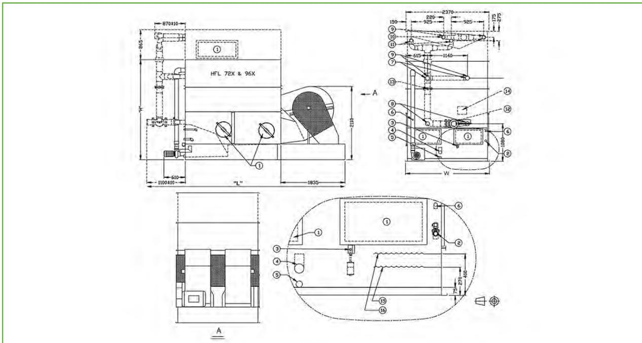
1. Доступ; 2. Подпитка; 3. Электрический поплавковый выключатель; 4. Перелив; 5. Слив; 6. Подсоединение обработки воды; 7. Подача воды в гладкий змеевик НД 100; 8. Выпуск воды из гладкого змеевика НД 100; 9. Воздушный клапан; 10. Подача воды в ТРТВ НД 80; 11. Выпуск воды из ТРТВ НД 80; 12. Трехходовой клапан; 13. Отверстие; 14. Клеммная коробка; 15. Рабочий уровень; 16. Уровень перелива.
