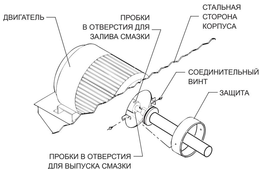
3. Вставьте пресс-масленки в отверстия смазочного заполнителя и добавляйте смазку, пока она не будет выходить через отводные отверстия.
