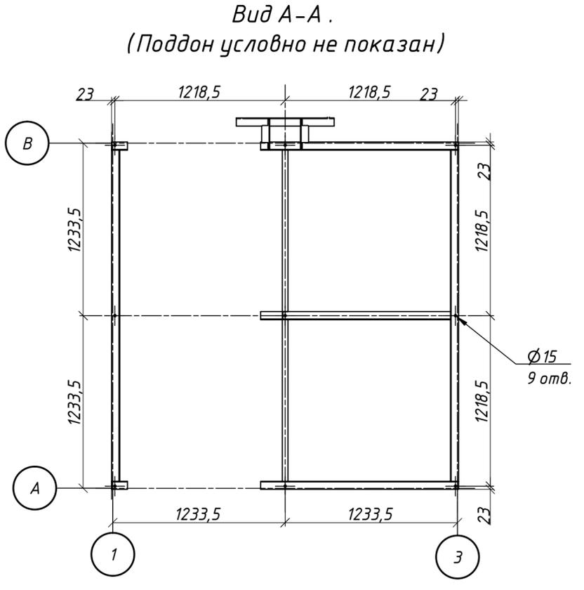
1. Материал конструкций каркаса градирни - стеклопластик и оцинкованная сталь.
