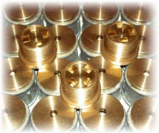
**4. Форсунка центробежная** создаёт равномерно заполненный факел разбрзгивания. Изготовлена из латуни, устойчивой к коррозии и кавитации, имеющей высокие прочностные свойства. Срок работы без замены – минимум 3 года.
