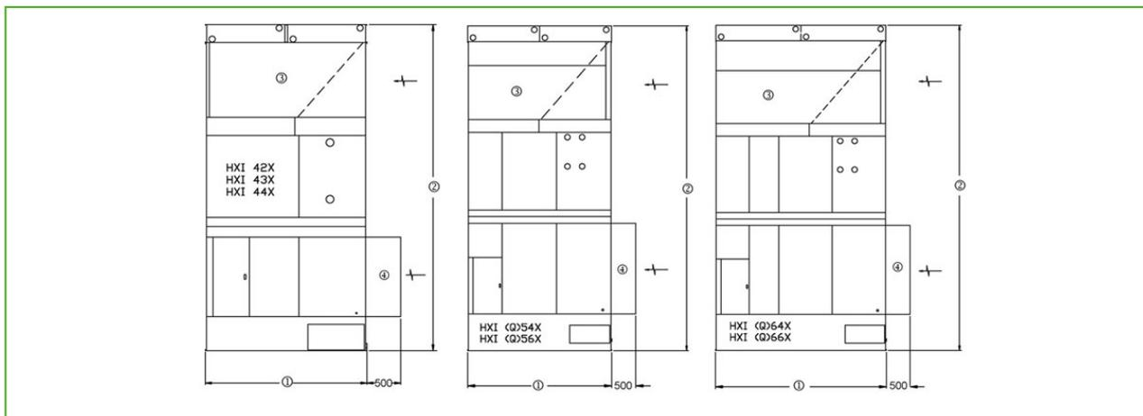
1. Ширина изделия; 2. Высота изделия; 3. Изолированная камера; 4. Впускной шумоподавитель.
